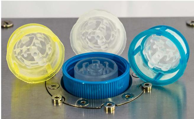
**Die patentierten Miniatur-Mühlen des TissueGrinder ermöglichen ein schonendes Herauslösen von Zellen aus einer Vielzahl von Gewebeprobe**
