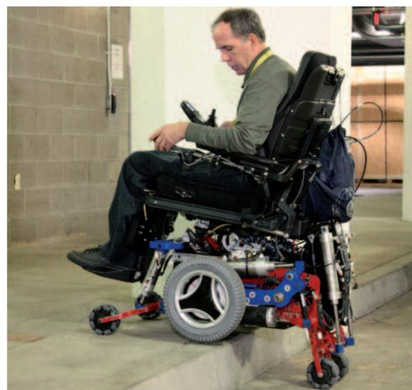
Roboter-Rollstuhl MeBot mit der Fähigkeit zum Treppensteigen.
