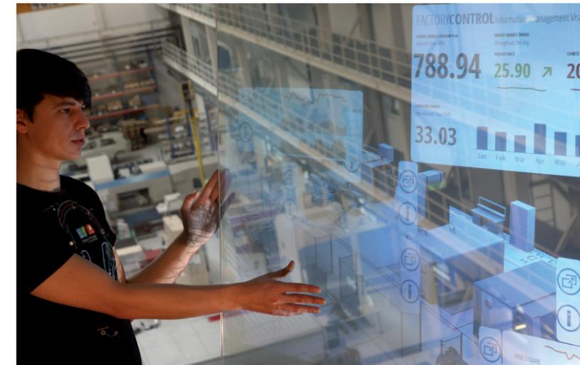
In der »gläsernen Leitzentrale« fließen die Daten über alle benötigten Ressourcen, wie bspw. Druckluft, Wasser, elektrische Energie sowie Maschinen- und Prozessdaten auf Fabrikebene zusammen. Die Wissenschaftler können die Informationen in Echtzeit auf einem Dashboard visualisieren und so Abläufe energie- und rohstoffsparender gestalten. Die transparenten Glasmonitore erinnern an »Holodecks« und sind über Gestensteuerung bedienbar. Quelle: Fraunhofer IWU
