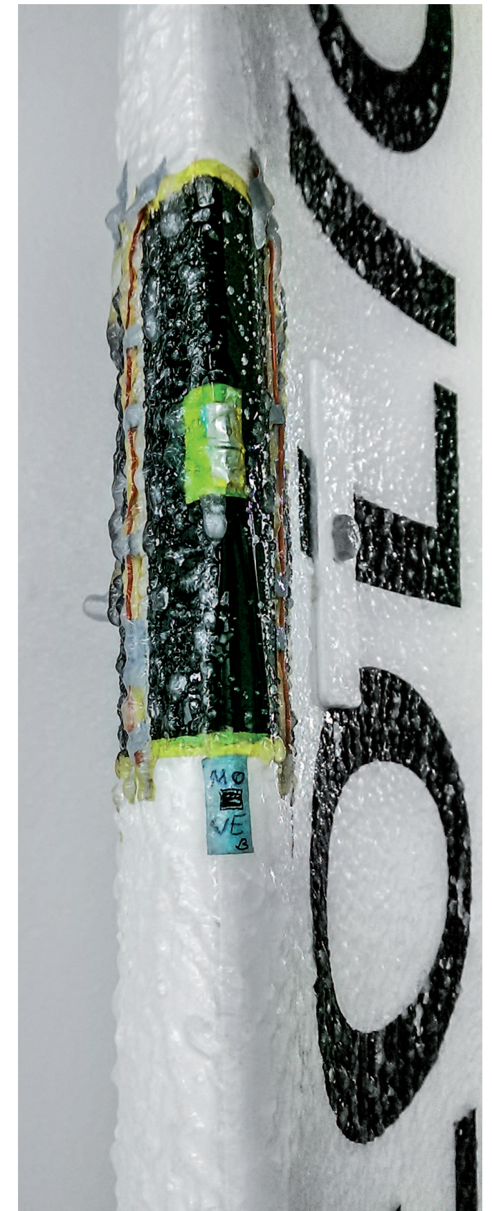
Das per CNT-Schicht beheizte Areal des Rotorblatts bleibt eisfrei.
