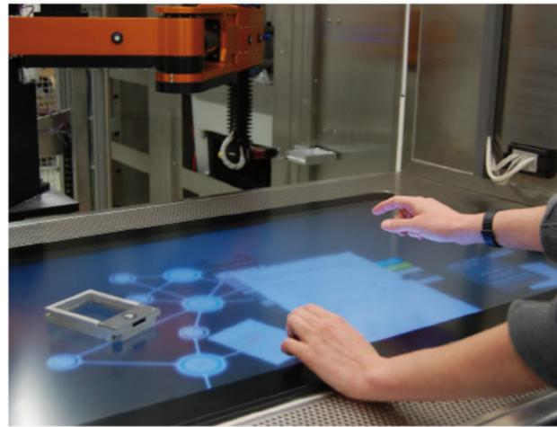
Die Arbeitsfläche wird zur interaktiven Bedienschnittstelle. Das digitale Laborbuch von MERLiN kommt somit dort zum Einsatz, wo es benötigt wird: Direkt in der Sterilbank. (Foto: Marc Arends, Quelle: Fraunhofer PAMB)
