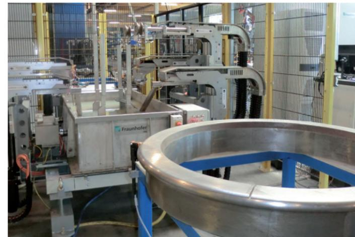
dischen Betrieb ein enormer Vorteil: Räder mit Durchmessern von 630 bis 1250 mm und bis zu 650 kg Gewicht können ohne Umbau lediglich durch Anpassung der Prüfprogramme in der Anlage untersucht werden.
