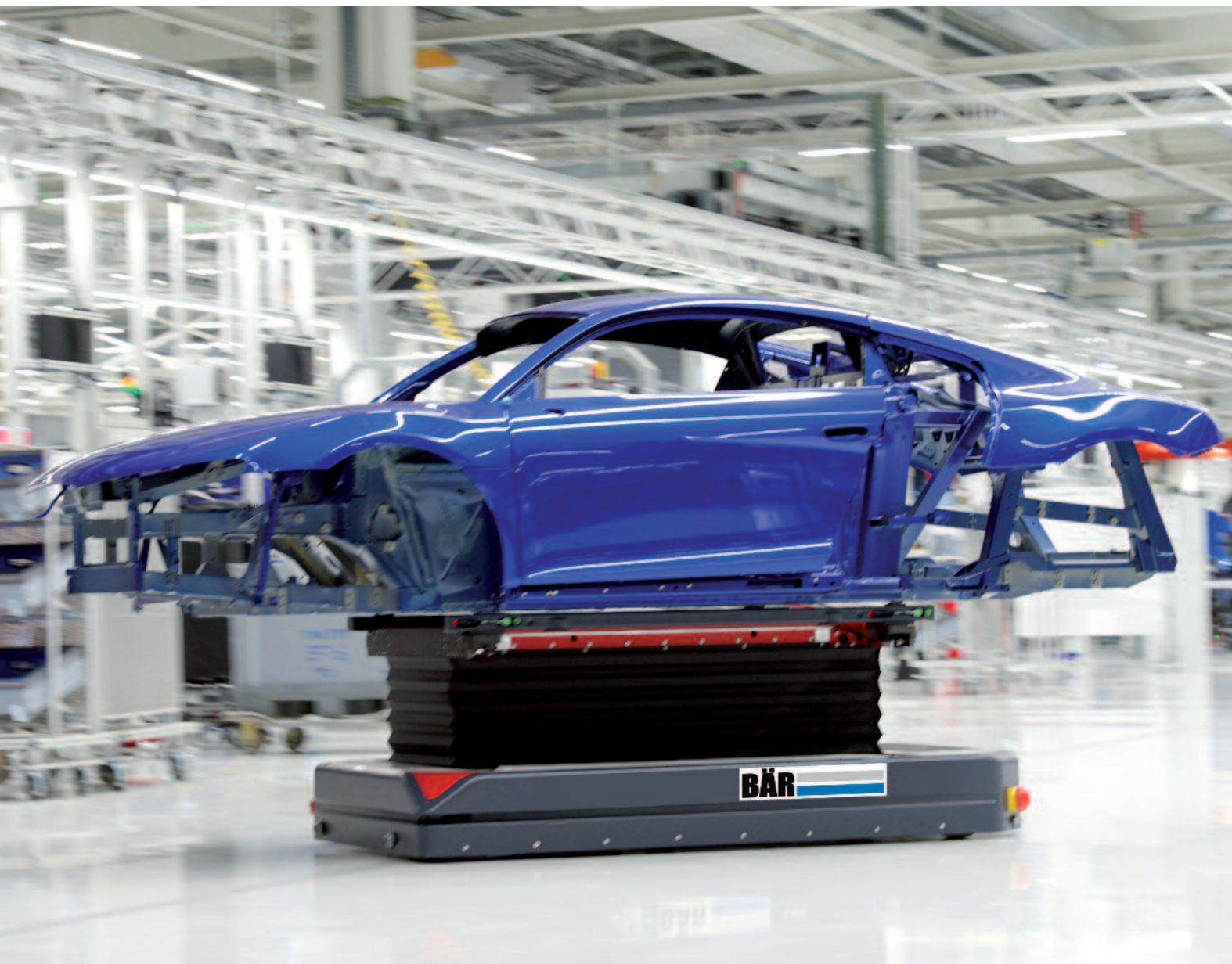
In der R8-Manufaktur von Audi navigieren fahrerlose Transportfahrzeuge autonom durch die Hallen.
